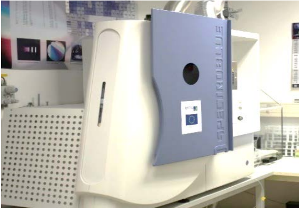
ICP OES System Spectro Blue mit Autosampler, Universität Rostock
